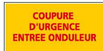
Figure 41: modèle d'étiquette pour l'identification des équipements
